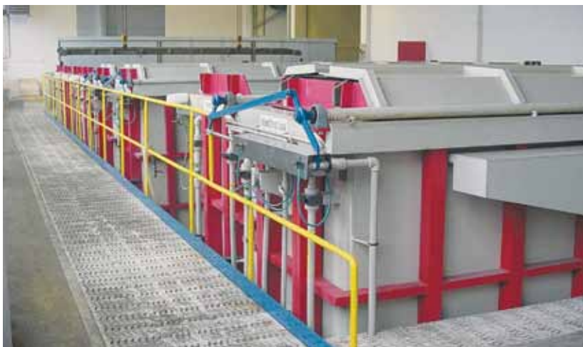
Eigenes Beizbad (L x B x H = 6300 x 1300 x 1600 mm) und Elektropolierbad (L x B x H = 2200 x 1200 x 1200 mm)
