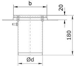
**2-teilige Ausführung** wie Typ ino 364-HF, komplett aus Edelstahl, Werkstoff 1.4301 (V2A), gemäß EN 1253, mit quadratischem Einlaufrand, mit zusätzlichem Deckendurchführungselement mit Pressdichtungsfansch zum Anschluss einer unteren Dichtungsebene.
